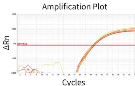
图2. 碧云天BeyoFast™ Probe qPCR Mix (含示踪染料)系列产品的稳定性检测效果图。将37°C保存3天与-20°C正常保存的本产品用于相同模板的扩增对比分析, 结果显示以上两种储存条件下qPCR产物CT值基本无差异。本系列产品的效果图以BeyoFast™ Probe qPCR Mix (含示踪染料) (D7616)为例, 实际结果会因实验条件、检测仪器等的不同而存在差异, 图中数据仅供参考。
