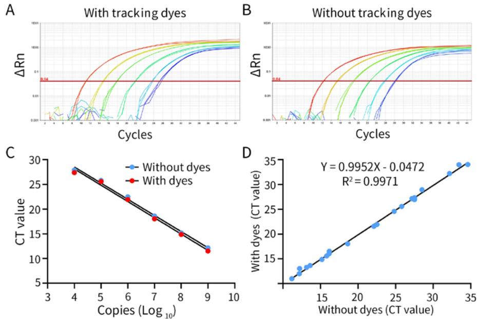
图1. 碧云天BeyoFast™ Probe qPCR Mix (含示踪染料)系列产品与BeyoFast™ Probe qPCR Mix (2X)系列产品的扩增效果对比图。如图A-C所示, 将初始浓度为10ng/μl的标准品质粒进行6个10倍梯度稀释, 分别使用添加双重示踪染料的本产品(With tracking dyes)和未添加示踪染料的本产品(Without tracking dyes)进行扩增检测。图A、图B分别为本产品和D7272的扩增曲线图; 图C为根据图A和图B扩增曲线的CT值绘制标准曲线, 横坐标为稀释后的样品经计算后的拷贝数的对数(Log<sub>10</sub>), 纵坐标为对应的CT值; 图D为分别使用添加双染料示踪指示剂的本产品和D7272对30个基因进行扩增, 横、纵坐标分别为D7272和本产品扩增不同基因的CT值, 结果显示两个产品使用效果基本一致。本系列产品的效果图以BeyoFast™ Probe qPCR Mix (含示踪染料) (D7616)为例, 实际结果会因实验条件、检测仪器等的不同而存在差异, 图中数据仅供参考。
